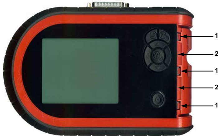
Abbildung 6-1 Austausch der Display-Abdeckung
