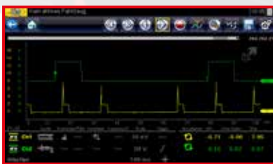
Im Hintergrund laufende Filmfunktion erleichtert das Auffinden von sporadischen Fehlern und ermöglicht z.B. eine Langzeitmessung des Ruhestromes.
