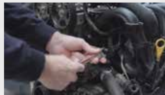
Eindrehen von Stehbolzen
